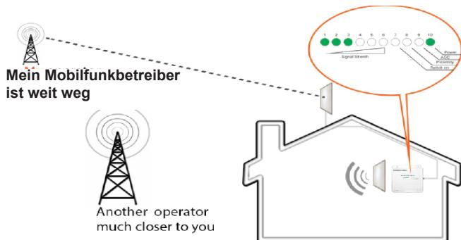
Vergewissern Sie sich, dass die Außenantenne hoch oben auf dem Gebäude befestigt ist und in Richtung des richtigen Betreibermasts zeigt. Wenn Sie Vodafone nutzen, muss die Außenantenne in Richtung eines Vodafone Masts zeigen. Drehen Sie die externe Antenne um 360° um das stärkste Signal zu finden bis Sie einen besseren Empfang auf Ihrem Telefon erhalten.
